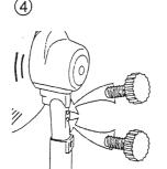
●以取出的2個附屬專用膠頭螺絲,對準接合部的2個別位,依順時針的方向直接鎖緊。
