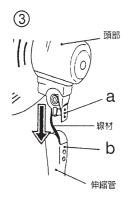
●依頭部的指示位置(如圖a) ,插入伸縮管的指示位置( 如圖 b),互相接合。
