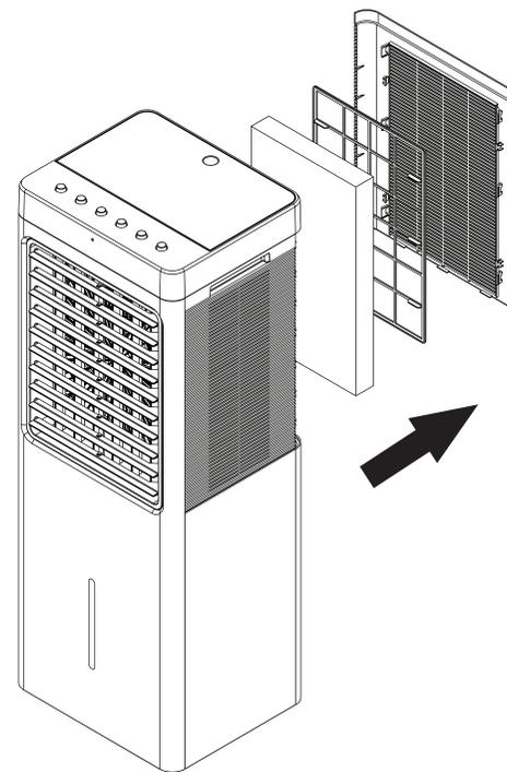
拆下安裝在機器上的後檔板，然後如上箭頭所示將紙簾拉出。
