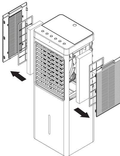
拆下安裝在機器上側邊的側檔板，然後如上箭頭所示將紙簾拉出。
