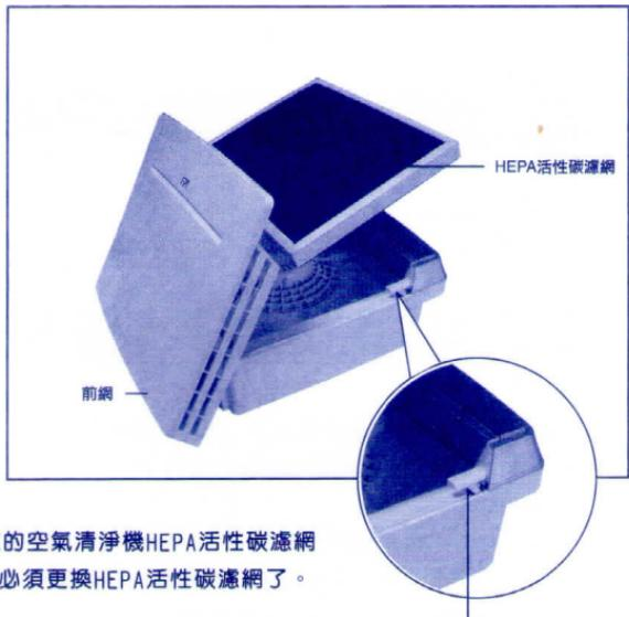
HEPA濾網指示燈亮時，表示您的空氣清淨機HEPA活性碳濾網使用時數累積已達二千小時，必須更換HEPA活性碳濾網了。
